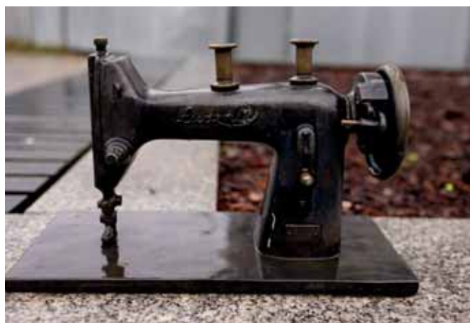
Maszyna do szycia Łucznik Kl. 82. Była to pierwsza maszyna do użytku domowego, produkowana w Zakładach Metalowych im. gen. Waltera.
